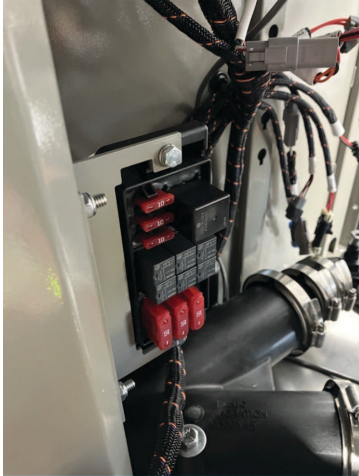
Centre de distribution de puissance, situé à l'intérieur du boîtier du QuickDraw
